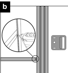
Instalar la hebilla con clavos en el bastidor que sostendrá el panel en su lugar
