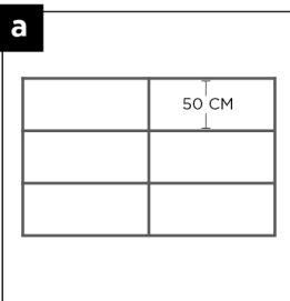
Instalar los bastidores bases del sobre muro espaciándolos máximo a 50 cms entre ellos
